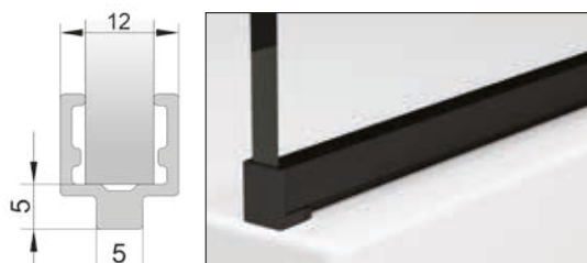
Profil aluminiowy chroniący dolną krawędź szkła i ułatwiający montaż.
